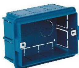
Scatole combinate da incasso a volume maggiorato con inserti in ferro filettati, finestre asportabili e accoppiabili simmetricamente tramite pioli di appoggio.
