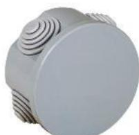
Scatole stagne con passacavi IP44 in materiale plastico isolante autoestinguente, fondo con guide predisposte per il montaggio di morsettiere, temperatura di utilizzo da -5°C a +60°C.
